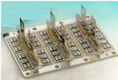
IGBT(Insulated Gate Bipolar Transistor), 绝缘栅双极型晶体管，是由 BJT(双极型三极管)和 MOS(绝缘栅型场效应管)组成的复合全控型电压驱动式功率半导体器件，兼有 MOSFET 的高输入阻抗和 GTR 的低导通压降两方面的优点。GTR 饱和压降低，载流密度大，但驱动电流较大;MOSFET 驱动功率很小，开关速度快，但导通压降大，载流密度小。IGBT 综合了以上两种器件的优点，驱动功率小而饱和压降低。非常适合应用于直流电压为 600V 及以上的变流系统如交流电机、变频器、开关电源、照明电路、牵引传动等领域。
